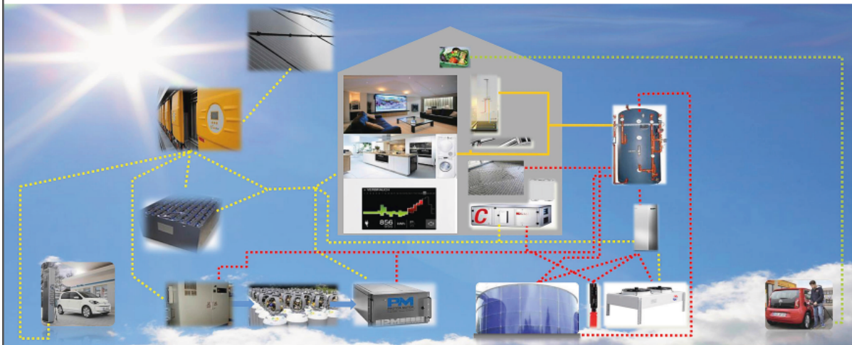
Das Konzept der Energieautarkie basiert vor allem auf der Solarstromproduktion und Nutzung von Niedertemperaturwärme. Im Verbund werden unterschiedliche Energieumwandlungs- und Speichertechnologien eingesetzt. Systemkomponenten (im Gegenuhreigersinn): Solarstromproduktion 150 kWp auf Dach/Fassaden ergibt ca. 100 000 kWh/Jahr, Wechselrichter, Batteriespeicher, Elektrofahrzeug, Elektrolyseur, Wasserstoffspeicher, Niedertemperatur-Brennstoffzelle, zwei Wärmespeicher (Wasser, total 240 m 3 ), zwei Erdwärmesonden (EWS, je 385 m tief), Wärmetauscher Umgebungsluft, Erdgasfahrzeug (betrieben mit Methan aus Grünabfall), Wärmepumpe, Warmwasserspeicher. Im Gebäude erkennbar: u. a. Duschen mit Joulia-Wärmerückgewinnung. (Bild: Umwelt Arena/Roger Balmer)
