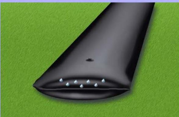
Sauberes Abwasser entweicht dem Tencate Geotube®. Über 99% der Feststoffe werden zurückgehalten, das klare Abwasser wird gesammelt und dem Werdenbergersee wieder zurück geleitet.
