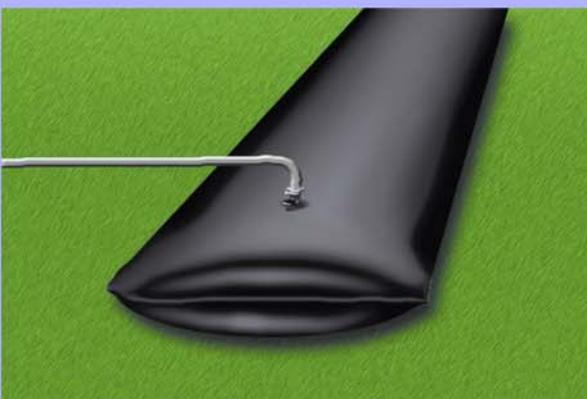
Durch die Druckleitung gelangt der Schlamm in den Tencate Geotube®. Umweltfreundliche organische Flockungsmittel werden dem Schlamm beigemischt, diese binden die feinen Schlammteilchen und trennen sie vom Wasser.
